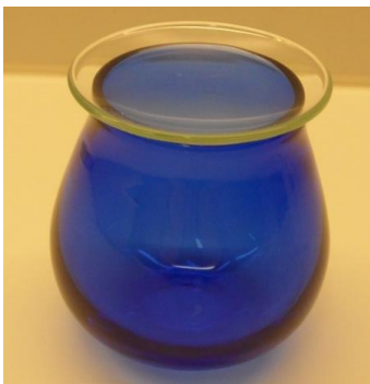
Abbildung 6: Standardisiertes Prüfglas mit Uhrglas
