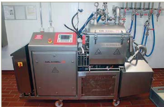
Abb. 7: Dieser Mischer von Karl Schnell im Wangener KS-Innovationscenter kann für verschiedene Lebensmittel, auch bei der Herstellung von Schmelzkäse oder von veganen Alternativen, zum Einsatz kommen.
